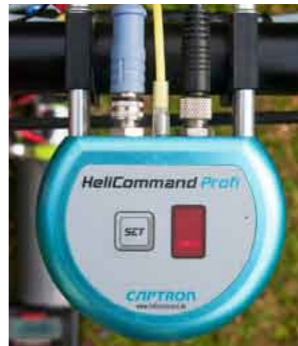
HeliCommand Profi har tre anslutningar: RC-modul (till radio och servon), GPS-modul samt barometrisk port (den gula slangen).
