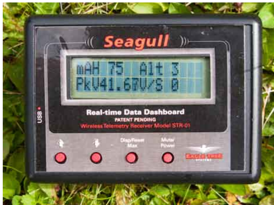
Seagull data dashboard. Integrerad telemetrimottagare och display. När jag flyger är jag primärt intresserad av batteristatus och höjd.
