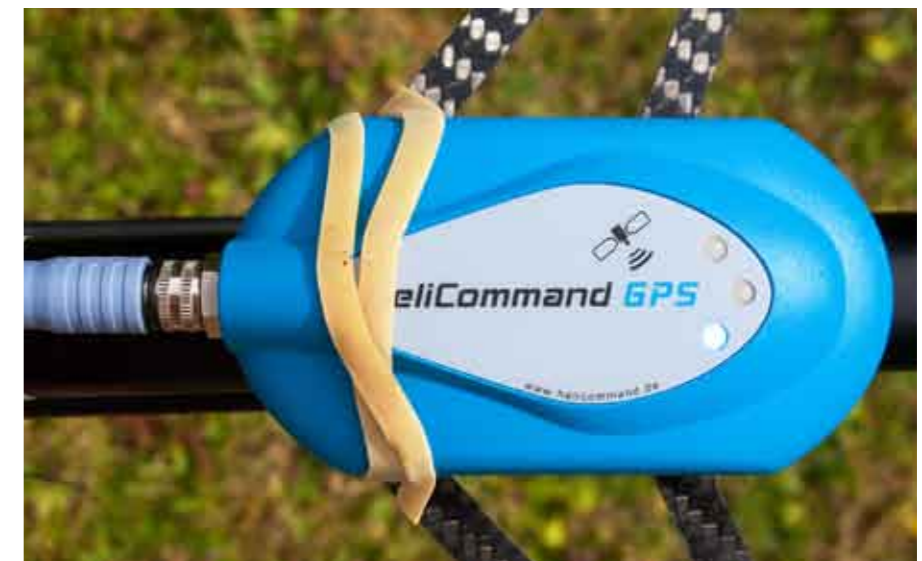
Eftersom GPS-modulen också innehåller en 3-axlig magnetometer måste den installeras på en plats fri från störande magnetfält.
