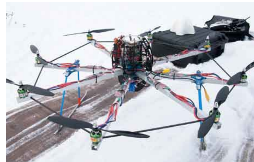
Ulf Grünbaums oktakofter. I centrum ett antal kretskort med sensorer, attityd-kontroll och navigationsenhet. Liten, lätt och avancerad. Tillverkare: MikroKopter
