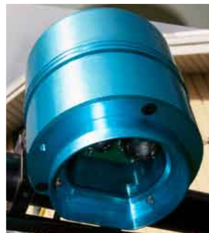
HeliCommand Profi underifrån. Bakom glasskivan sitter flera optiska sensorer, vilka används till höjd och fartmätning på lägre nivåer. Teoretiskt sett kan enheten landa helikoptern automatiskt.
